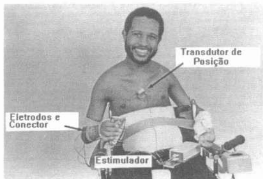
Figura 9. Sistema de substituição de preensão que utiliza movimentos voluntários dos ombros do paciente (extraído de Szeto e Riso, 1990).
